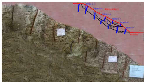
图 1 模型试验滑坡后轴线剖面及滑动面概化 Fig.1 Axis section and sliding surfaces
